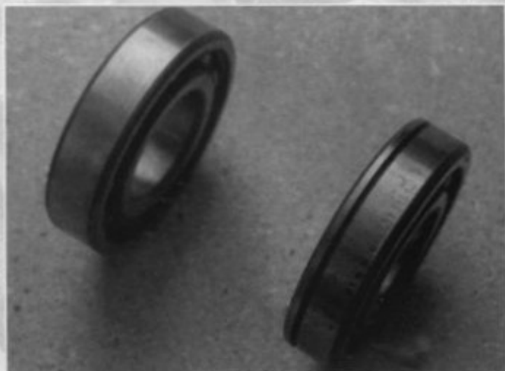
Bild links: Diese Teile sollte man parat haben: Simmeringe innen und außen, Radlager für innen und außen, Kronenmutter, Bremstrommelmutter, Sicherungsblech und Keil (Halbmond). An Splinten sollte man nicht sparen und deshalb immer neue verwenden. Eventuell noch neue Blechkappe mit Dichtung für den Spurstangenbolzen.
