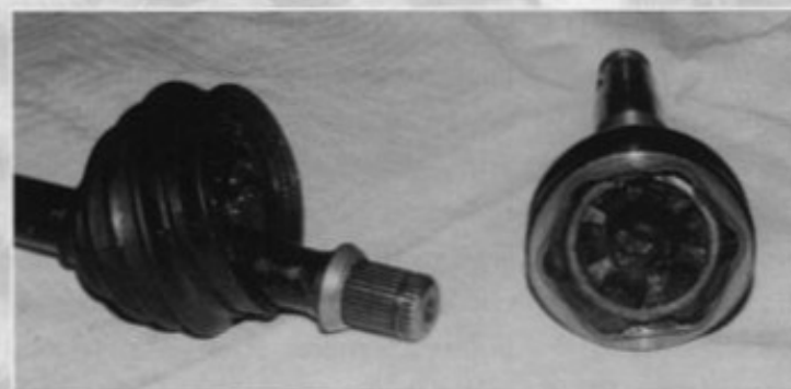
Bild oben: Innenleben einer Gleichlaufgelenkwelle mit Aufnahmekonus für die Bremstrommel des Traction. Bild rechts: Die Einzelteile der Kraftübertragung.
