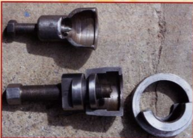
Die Mutter links im Bild hat ein Linksgewinde und ist entsprechend markiert, die Mutter rechts hat keine Markierung und hat somit ein „Normalgewinde“.
