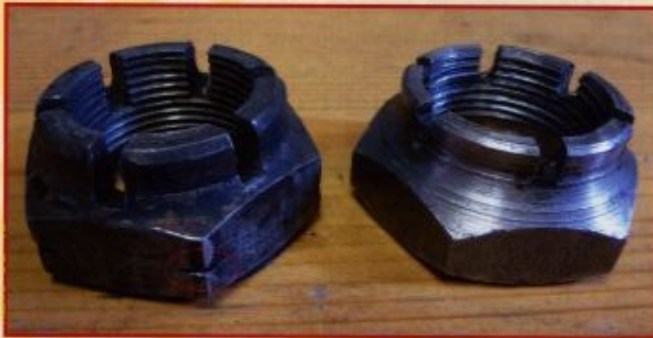
Die Mutter links im Bild hat ein Linksgewinde und ist entsprechend markiert, die Mutter rechts hat keine Markierung und hat somit ein „Normalgewinde“.
