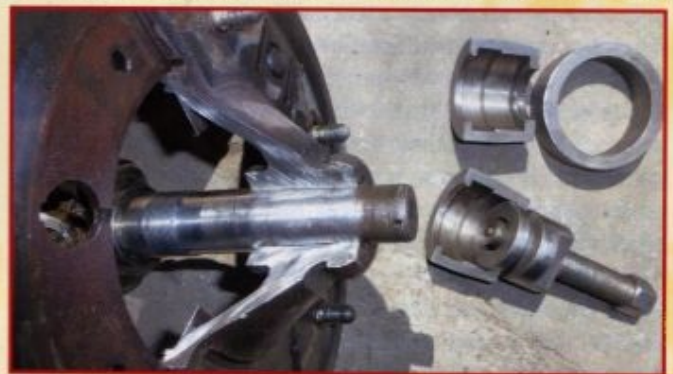
Die Mutter links im Bild hat ein Linksgewinde und ist entsprechend markiert, die Mutter rechts hat keine Markierung und hat somit ein „Normalgewinde“.
