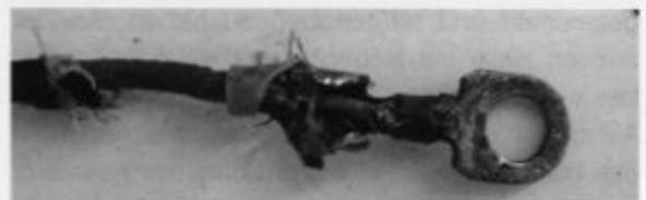
Isolierung der einzelnen Drähte zerbröselte beim Anfassen. Auch bestätigte sich die immer wieder vorgetragene Feststellung, dass an den Klemmen einzelne Drähte infolge Jahrzehnte langer Montagearbeiten und Erschütterungen abgebrochen waren. Da kann schon mal die Hälfte der Drähte ab sein und somit einen erheblichen Leistungsverlust verursachen.
